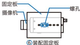
5) 将摄像机连同固定板安装在护罩中。
